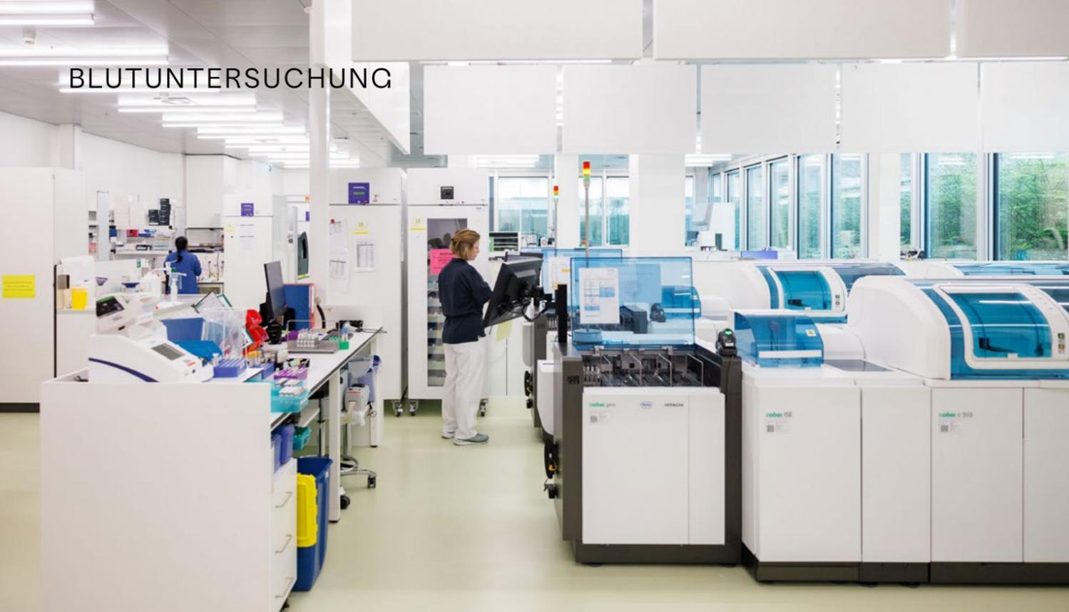
Jedes Analysegerät ist im Labor doppelt vorhanden, damit die nötigen Untersuchungen jederzeit sichergestellt werden können.
